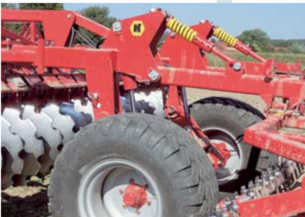
Das Fahrwerk ist bekannt von den Scheibeneggen. Die 500er Bereifung ist bei 4 t Achslast Minimum, die vorgeschriebene Bremse gibt es nur auf Wunsch. Die Tiefeneinstellung mit zwei Steckbolzen ist einfach, hat aber ein (zu) grobes Raster.
