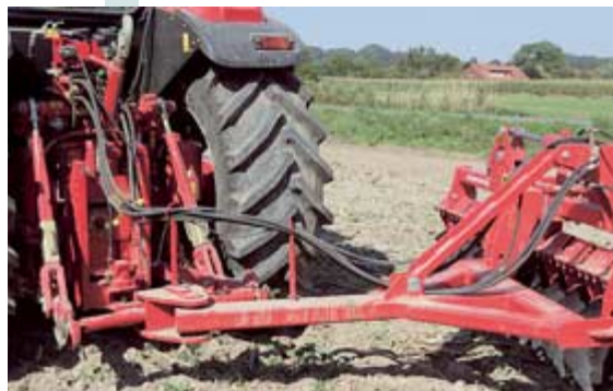
Die Anhängung macht das Gespann sehr wendig. Es sind zwei dw- (Fahrwerk, Klappung Scheiben) und ein ew-Steuerventil (Klappung Walze) notwendig. Der Galgen ist gut, eine ordentliche Markierung und Parkposition für die Schläuche ist laut Knoche in Vorbereitung.
