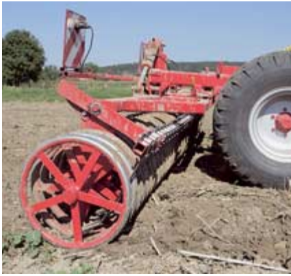
Die schwere Ringwalze ist am teuersten, macht aber auch sehr gute Arbeit. Die Beleuchtung wurde noch mal geändert und macht jetzt einen stabilen Eindruck.
